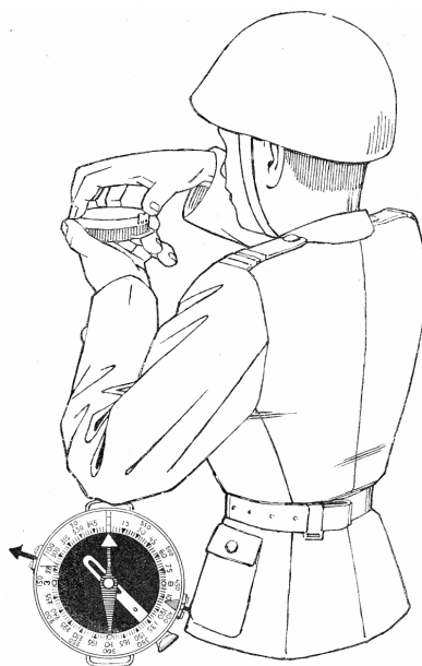
Wyznaczanie azymutu busolą Adrianową
